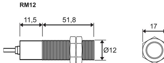
**Sensor Laser Diâmetro 12mm**
